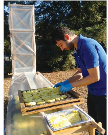
El secador solar de chimenea, diseñado por investigadores de UC Davis para el Horticulture Innovation Lab, fusiona la captación de calor solar con un flujo de aire veloz para secar eficazmente productos frescos.
